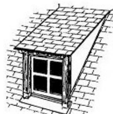
lucarne rampante ou en chien couché
